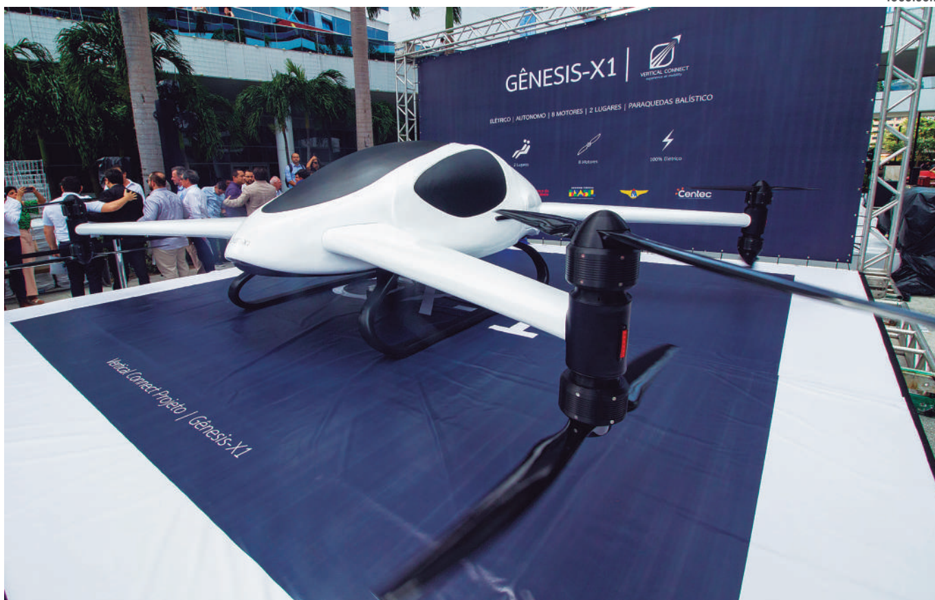
O modelo Genesis X1 terá capacidade para duas pessoas, com um tempo máximo de voo de 60 minutos e velocidade de até 130 km/h
